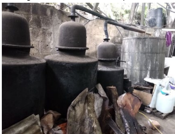
Figura 4. Alambiques en poshería tradicional Figure 3. Stills in traditional «poshería»
