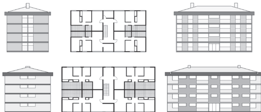
Figura 1. Plantas y elevaciones de Colectivos 1010 (arriba) y de Colectivos 1020 (abajo). Redibujo sobre base de material de Archivo Técnico Departamento de Obras SERVIU. M. Costas; 2018.
