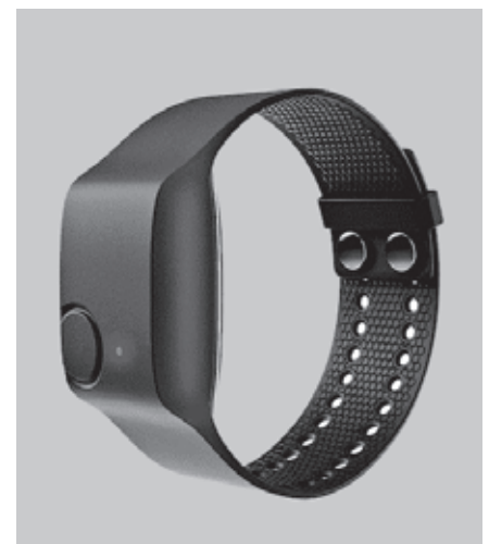
Figura 5. Pulsera Empatica E4, evalúa diversos parámetros fisiológicos, entre los cuales la frecuencia cardíaca y la respuesta galvánica de la piel 5 . Fuente: https://www.empatica.com/
