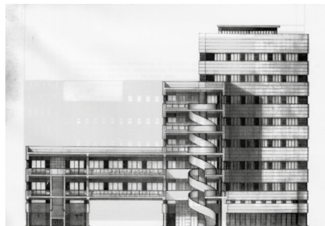
Figura 11. Croquis de estudio del interior y revestimiento. El tratamiento de los espacios interiores y el acabado de las fachadas consideran alternar losas de peperino en bandas horizontales con losas de travertino o cemento blanco.
